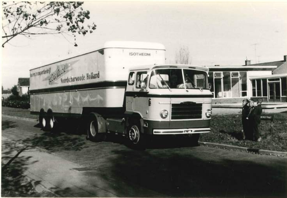
1961 UB 70.03 met Heiwo isothermoplegger 17.000 kg en Zabo cabine
